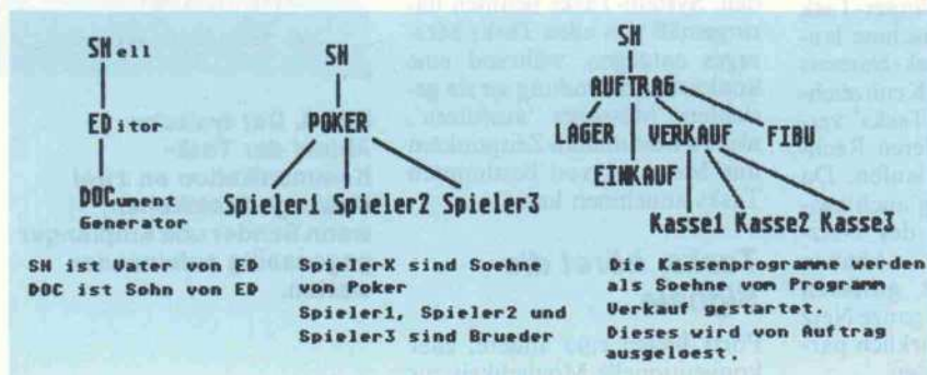
Bild 1. Bei Tasks unter QNX bestehen Hierarchien, die als 'Vater-Sohn-Konzept' erklärt werden.
